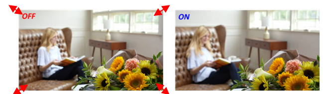
Compensation du « Focus Breathing » (variation du cadre en focale fixé lors du changement de mise au point)
