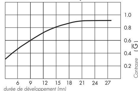
DELTA 3200 Professional développé en ILFOTEC DD-X 1+4, à 20°C, avec agitation intermittente.
