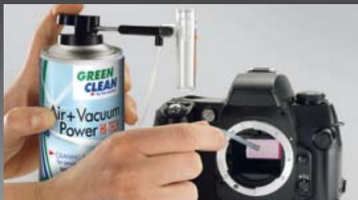
Tous les capteurs numériques CCD et CMOS ont des surfaces fragiles qu'il vaut mieux s'abstenir de toucher. La méthode d'élimination de la poussière sans contact Mini Vacuum prévient les dommages mécaniques à la surface des capteurs!
